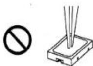
在批量作业时，吸嘴小于产品内径会导致吸嘴冲压硅胶，造成金线断裂，晶片受压而死灯。
